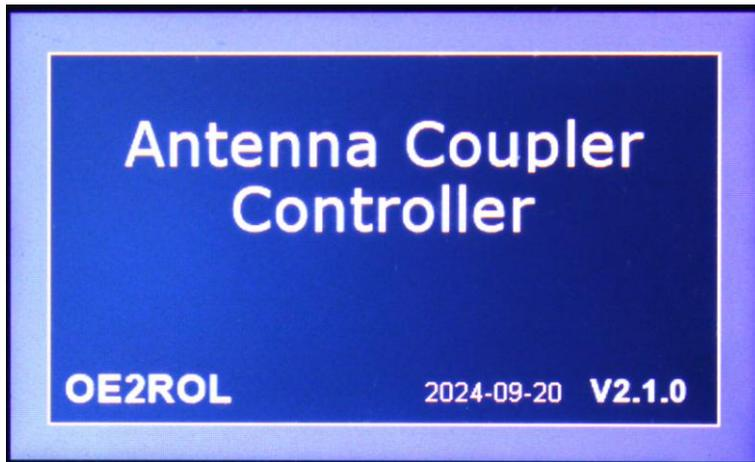
Beim Einschalten der Kopplersteuerung erscheint für einige Sekunden ein Startfenster, danach wird automatisch der Automode aufgerufen.
