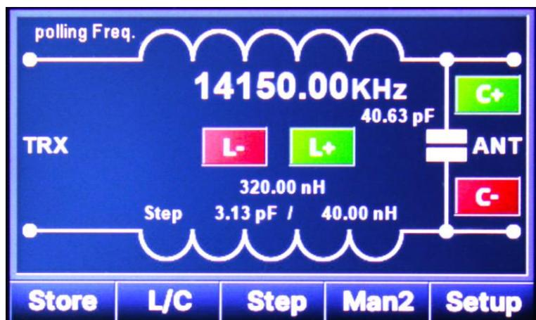
Im Mode Man2 kann die Induktivität und die Kapazität des Kopplers manuell eingestellt werden. Durch Betätigen der Tasten L+ oder L- kann die Induktivität eingestellt werden. Durch Betätigen der Tasten C+ oder C- kann die Kapazität eingestellt werden.
