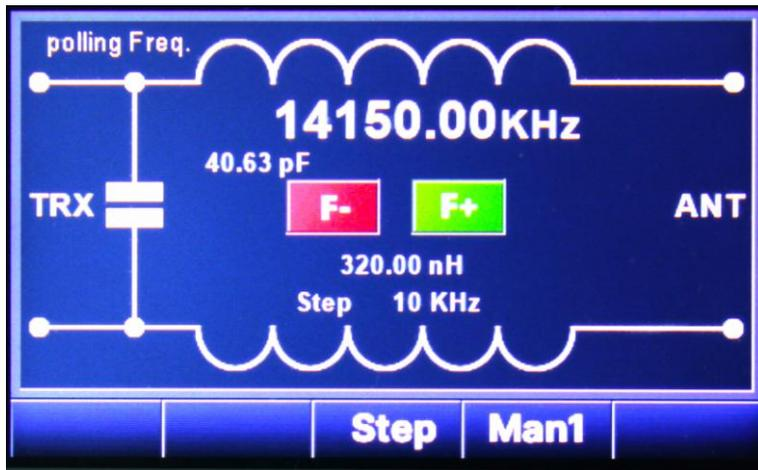
Wenn ein Transceiver ohne CI-V Schnittstelle verwendet wird, kann im Mode Man1 der Koppler durch manuelle Eingabe der Frequenz abgestimmt werden. Es wird die gerundete Frequenz angezeigt. Durch Betätigen der Tasten F+ oder F- kann die Frequenz eingestellt werden. Die Auswahl der Schrittweite kann durch Betätigen der Taste Step auf 10KHz, 100KHz oder 1000KHz eingestellt werden.
