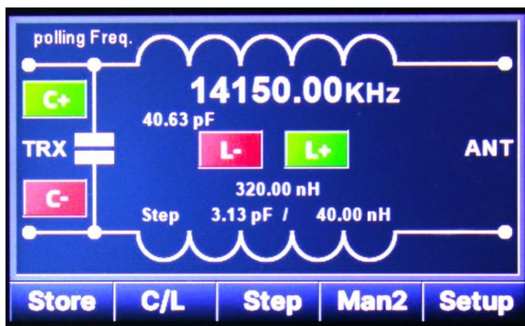
Die eingestellte Induktivität, Kapazität und die Position der Kapazität wird automatisch zum Koppler übermittelt.
