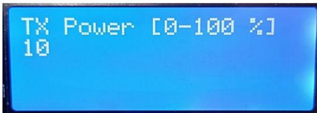
Die Ausgangsleistung kann durch Druck auf die up oder down Taste eingestellt werden. Diese eingestellte Leistung wird bei jeden Bluetoothpairing zum Transceiver gesendet.
