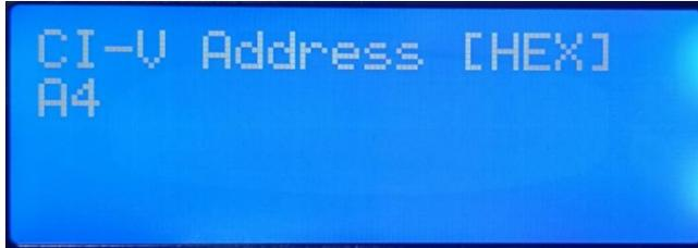
Die Geräteadresse kann durch Druck auf die up oder down Taste eingestellt werden.
