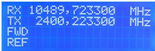
In der Frequenzanzeige wird die RX Frequenz nach einer Verzögerungszeit von 3,5s aktualisiert.
