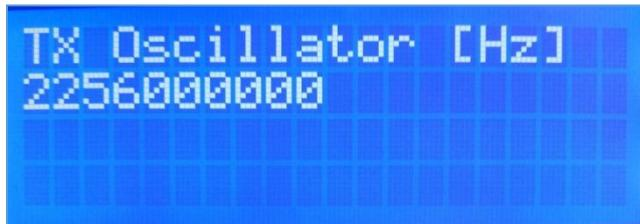
Durch einen Druck auf die „Menü“ Taste kommt man in den Einstellbereich der TX-Oszillatorfrequenz.
