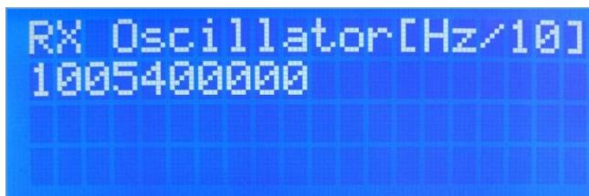
Durch einen weiteren Druck auf die „Menü“ Taste kommt man in den Einstellbereich der RX-Oszillatorfrequenz.
